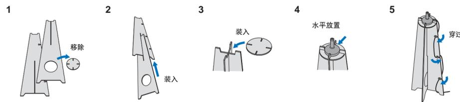
使用随附的纸板麦克风支架将 IntelliBeam 麦克风放置在与您采取坐姿时的双耳齐平的高度。确保视听室内的 IntelliBeam 麦克风和墙壁之间没有障碍物，因为这些物体会阻碍音束的通道。
